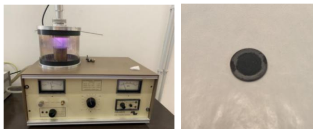
Figura 16: Macchina per la deposizione del rivestimento sulla superficie della semicella (a sinistra); Semicella dopo il rivestimento (a destra).
