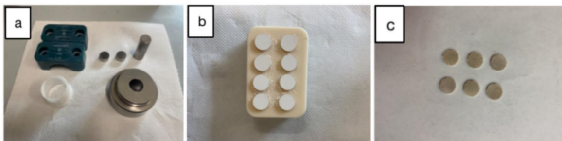
Figura 13: Stampo per la produzione dei dischetti di elettrolita (a); polvere di GDC compresso in blocchi (b); elettrolita GDC dopo la cottura (c).
