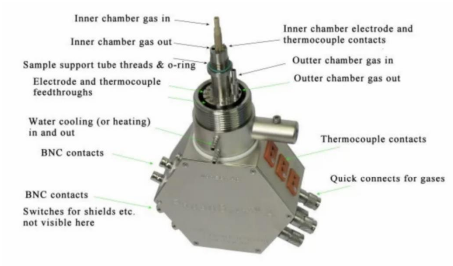
Figura 29: Componente della base del sistema ProboStat™ [41].
