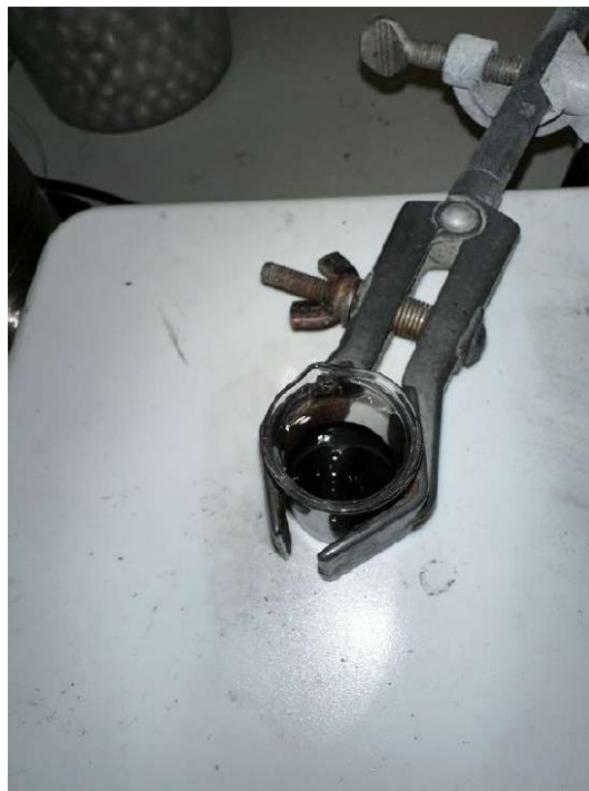
Figura 22) Slurry posto sotto agitazione, la superficie riflettente è indice di una omogenizzazione ottimale delle polveri.
