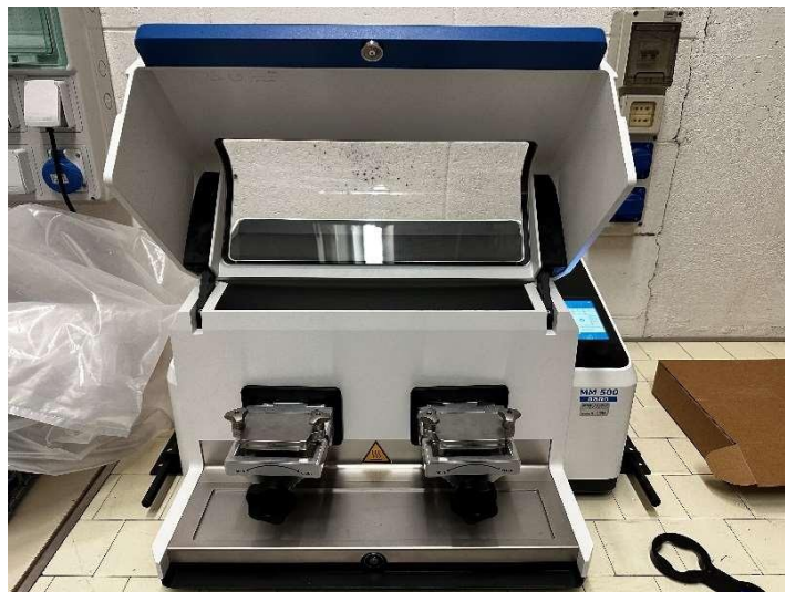
Figura 19) Ball miller caricato con le giare per il trattamento di macinazione della grafite.
