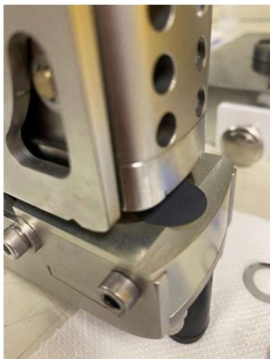
Figura 24) Elettrodo tagliato (la carta oleate impiegata come protezione è stata rimossa per la foto).
