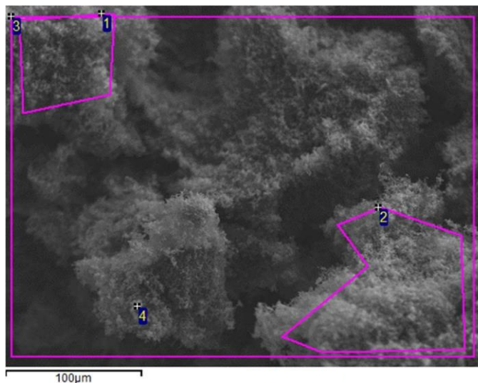
Figura 32) Aree e punti di analisi tramite sonda EDS per il campione PE_1000_BM_doppio.
