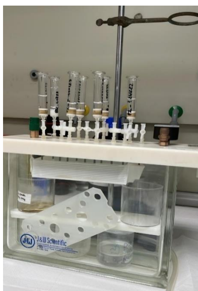
Figura 40. Foto della strumentazione per l'eluizione delle SPE.
