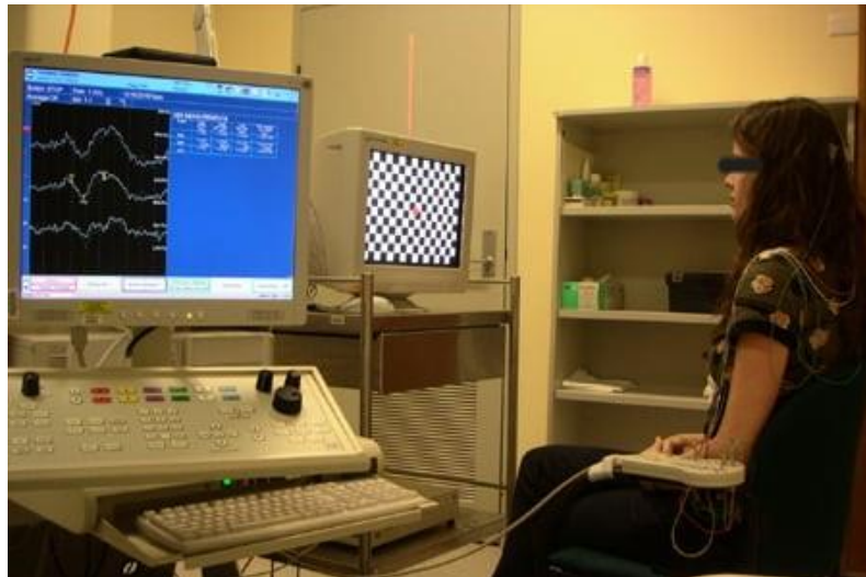
Figura 7 set-up di misurazione dei potenziali evocati visivi[81]
