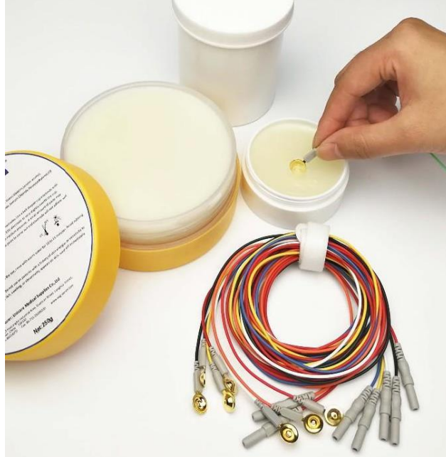
Figura 14 elettrodi commerciali per EEG, pasta abrasiva e gel elettrolitico, necessari per effettuare misure con le strumentazioni attuali.
