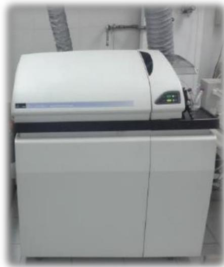
Figura 2.12 – ICP-MS ELAN DRC II PerkinElmer-Sciex utilizzato per la determinazione del  $Fe_d$  totale
