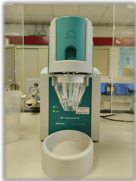
*Figura 2.14 – Sistema voltammetrico per la determinazione della speciazione del Fe*
