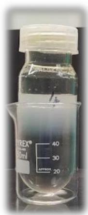
*Figura 2.6 – Campione immediatamente dopo l'aggiunta della soluzione di ammoniaca*
