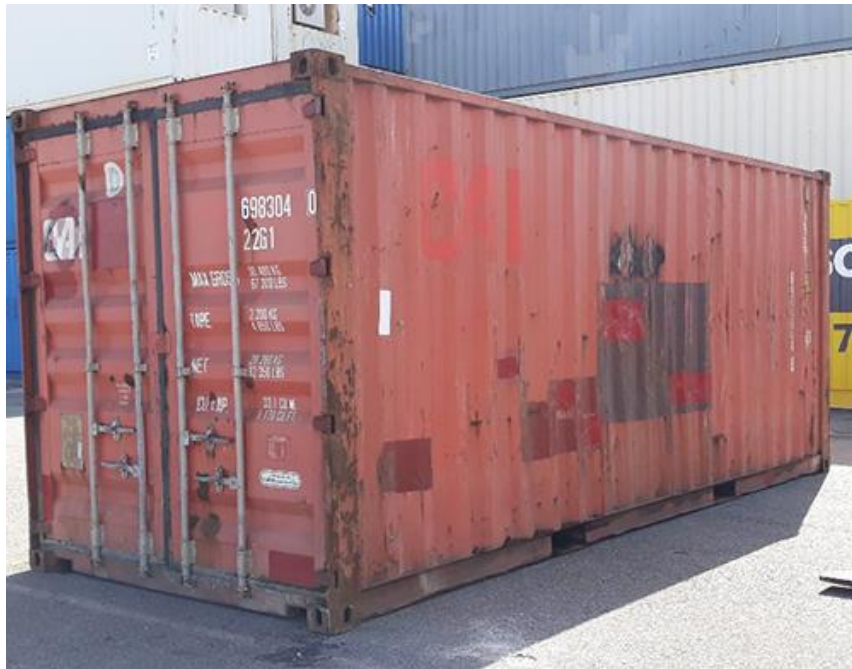
Illustrazione 3.10 – Condizioni estetiche esterne di un container di grado C
