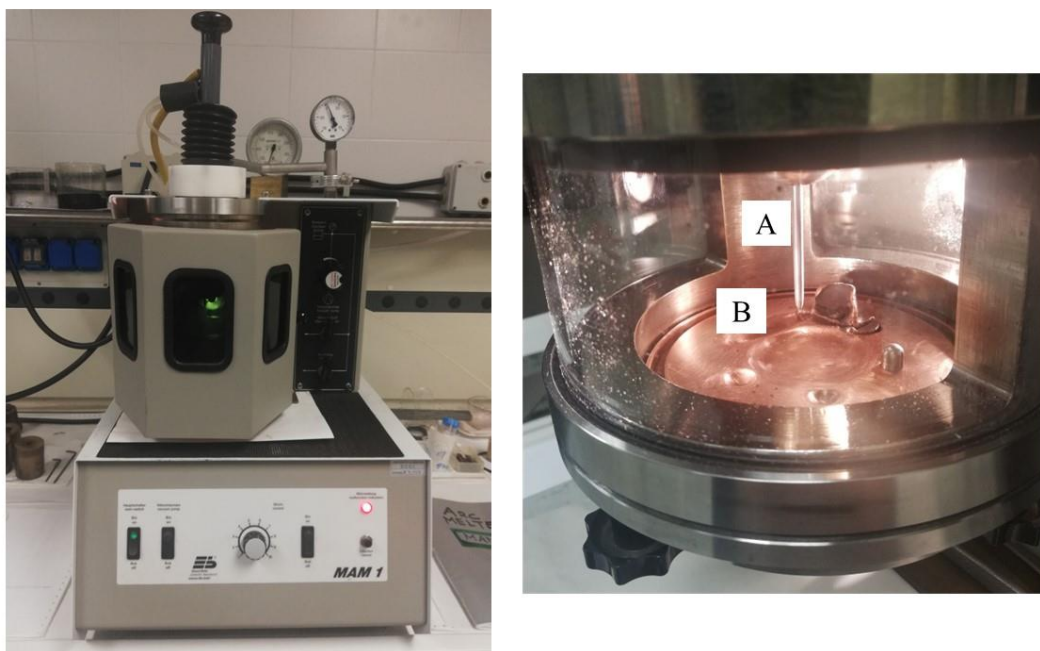
Figura 25: foto del forno ad arco utilizzato (MAM-1, Edmund Bühler GmbH); a sinistra visione da fuori, a destra visione della camera di fusione: A è il puntale di W, B la base in Cu.
