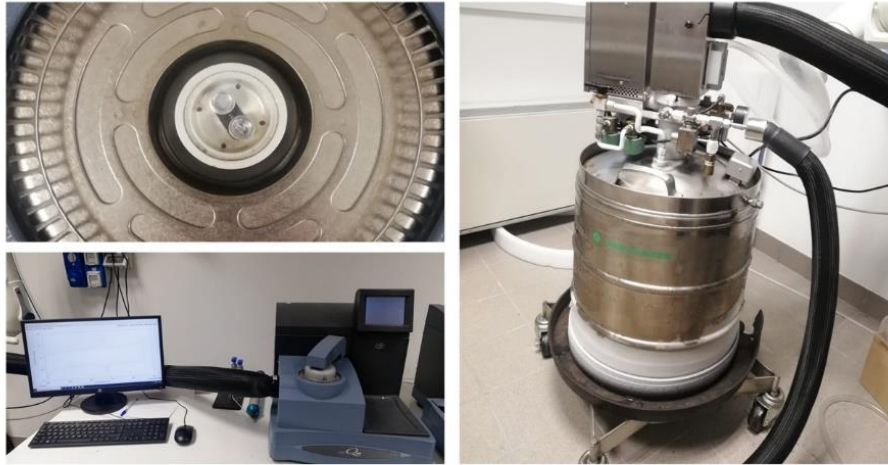
Figura 31: strumento DSC (Q200 TA Instruments). In alto a sinistra il pan con campione e riferimento, in basso a sinistra lo strumento e il monitor; a destra il dewar riempito con N_2 liquido.
