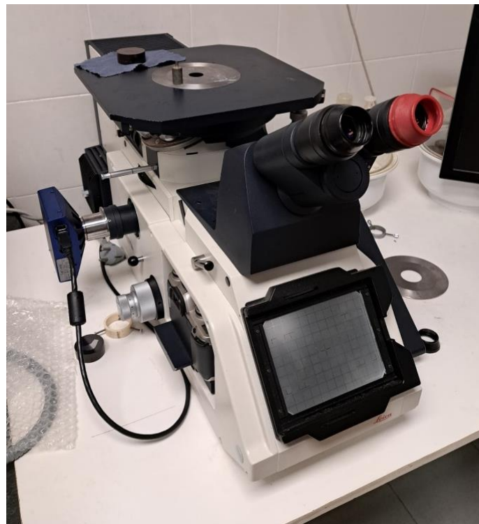
Figura 27: foto LOM utilizzato, modello Leica MEF4M.
