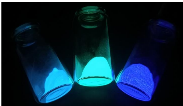
Figura 15: Rappresentazione dell'emissione al buio dei 3 PeL commerciali dopo l'esposizione alla lampada solare.
