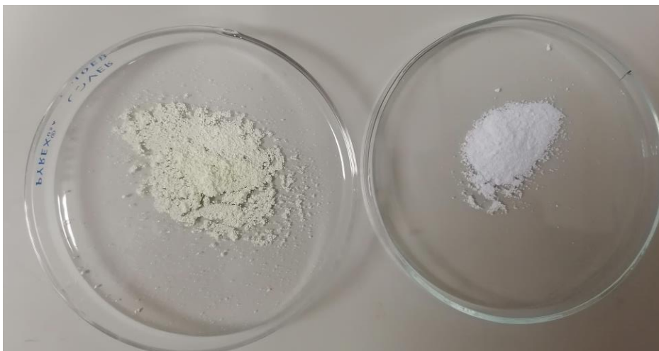
Figura 20: Dettaglio della differenza di colorazione tra il campione di \text{TiO}_2 relativo all'exp 4 (sx) e uno esempio di \text{TiO}_2 non drogato.
