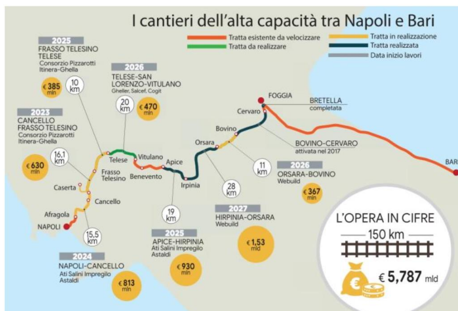
Fig. 3.1 I cantieri dell'alta capacità tra Napoli e Bari
