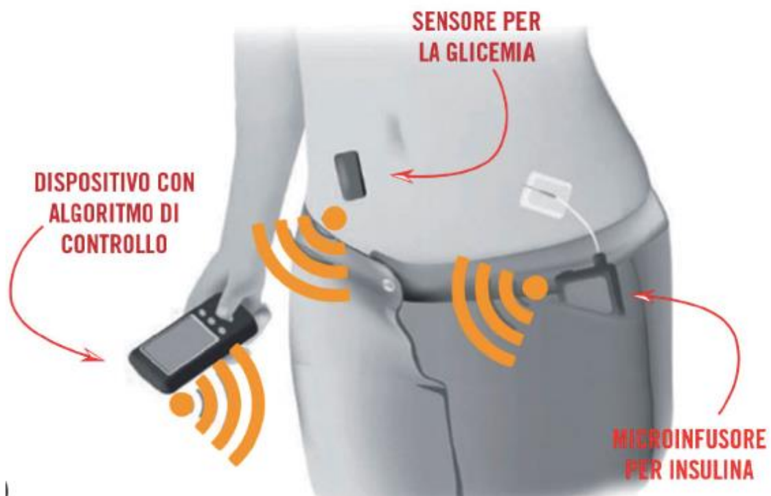
Figura 5: Un prototipo di sistema a circuito chiuso: comprende un sensore e un ricevitore per il monitoraggio continuo del glucosio (GCM), una pompa per l'insulina ed un algoritmo di controllo all'interno di un dispositivo collegato via wireless
