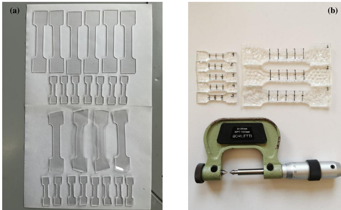
Figura 10. Campioni di PETG e PETG termoformato dopo aver ricavato i provini con la fustellatrice (a) e campioni di TC-85 stampati (b).
