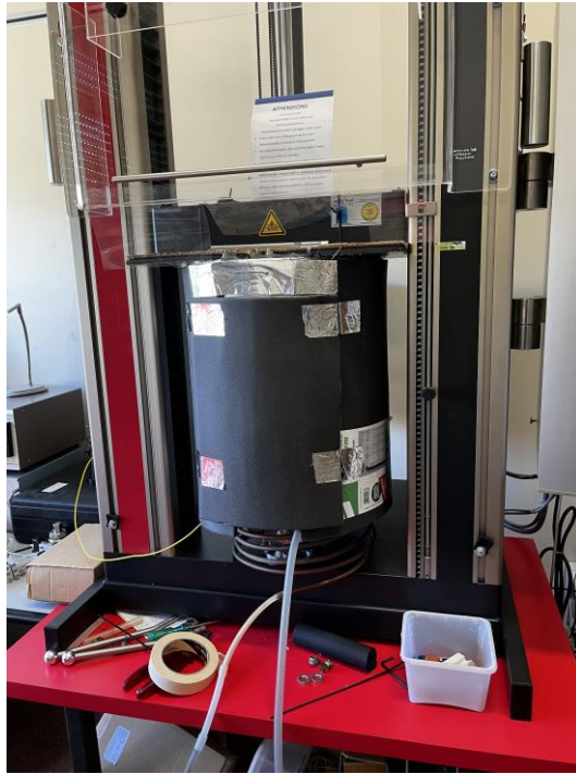
Figura 19. Sistema con copertura isolante.
