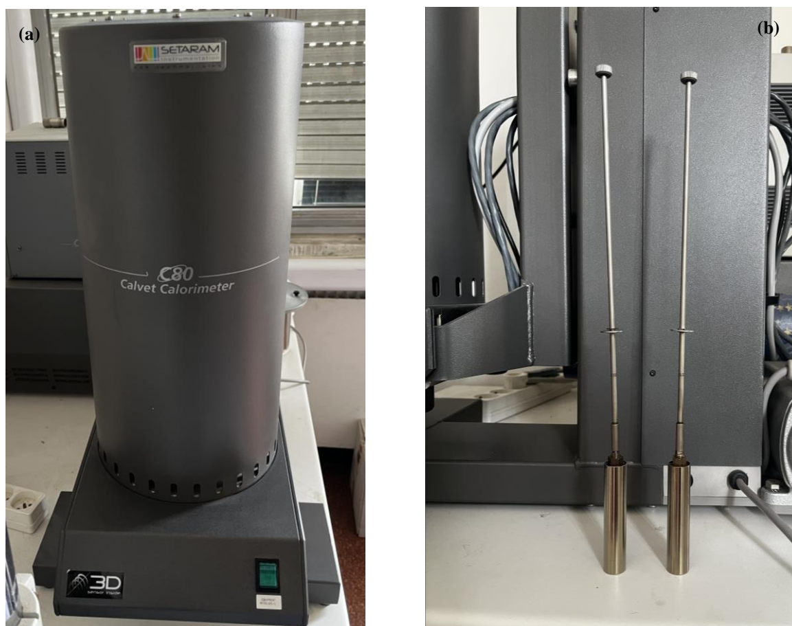
Figura 22. Calorimetro Calvet C80 (a) e celle di riferimento e di misura (b).
