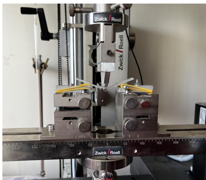
Figura 14. Esempio di prova di flessione a tre punti eseguita su un campione di PETG.
