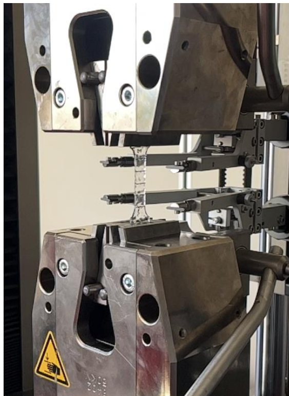
Figura 16. Esempio di prova a trazione eseguita su un campione di TC-85.
