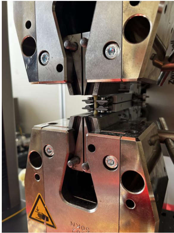
Figura 25. Esempio test a trazione su campione stampato.
