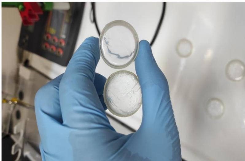
Figure 3.7 Coperchi di polidimetilsilossano PDMS.
