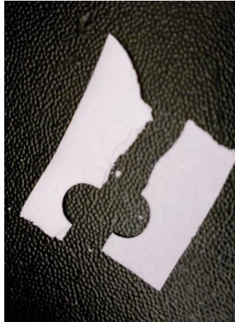
Figura 3.19 Notevole fragilità di una membrana PLA_10_DMF amminolizzata per il tempo di 30 minuti
