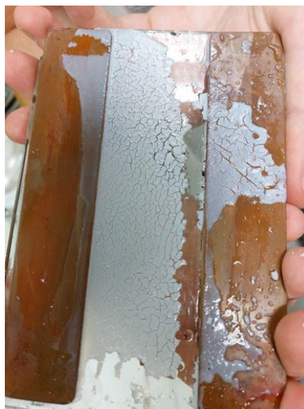
Figura 3.5 Residuo di soluzione di PLA in astrobio rimasto adeso sul supporto vetroso
