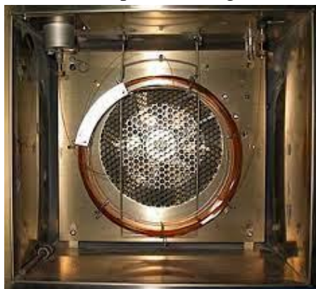
Figura 11: Interno del forno in cui è possibile osservare la colonna capillare
