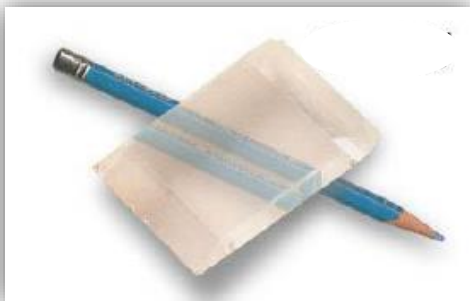
FIGURA 2.2.2.1 – Esempio di birifrangenza di cristalli di calcite
