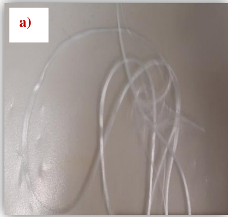
FIGURA 2.1.2.4- a) Fibra di Vetro e b) Fibra di vetro visto in microscopio Leica con un diametro \sim 32 micrometri
