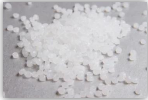
FIGURA 2.1.1.2 - Polipropilene isotattico, sotto forma di pellet
