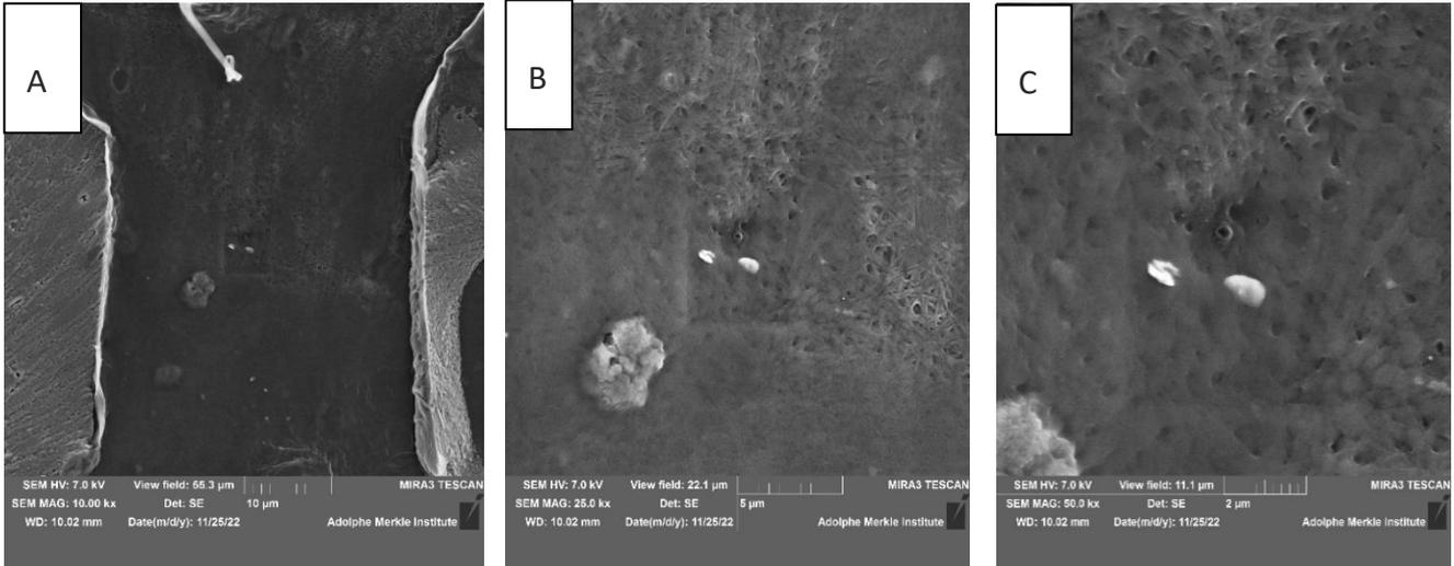
Figura 38 Membrana CS/PEO\_4% coagulata con vapori di  $NH_3$  a diversi ingrandimenti: A=10000X, B=25000X e C=50000X
