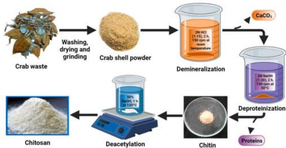
Figura 4 Processo di estrazione della chitina e del chitosano
