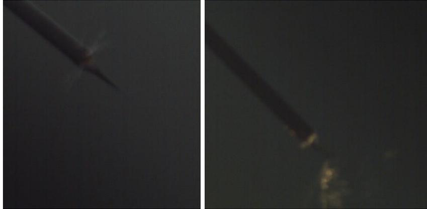
*Figura 33 Immagine della formazione del cono di Taylor durante l'elettrofilatura*
