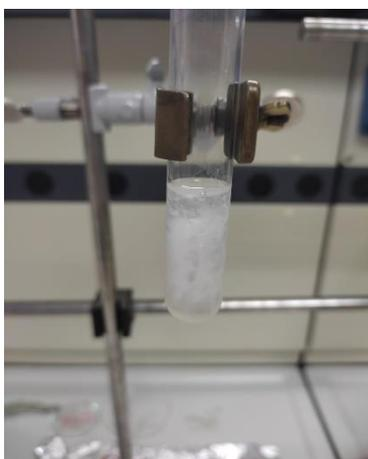
*figura 13: foto del precipitato formato quando una soluzione di CH viene posta a contatto con una di DNA*
