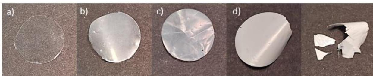
*Figura 23: foto dei film di PLA tal quale a) PLA amminolizzato b) PLA tal quale c) PLA amminolizzato 0.5h d) PLA amminolizzato 1h e) PLA amminolizzato 2h f) PLA amminolizzato 3h*
