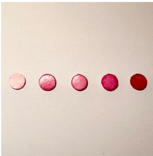
Figura 34: da SX, fotografie dei campioni PLA_100, PLA_PCL_95_5, PLA_PCL_90_10, PLA_PCL_85_15, PLA_PCL_80_20 a seguito della prova di adsorbimento di pararosanilina cloridrato
