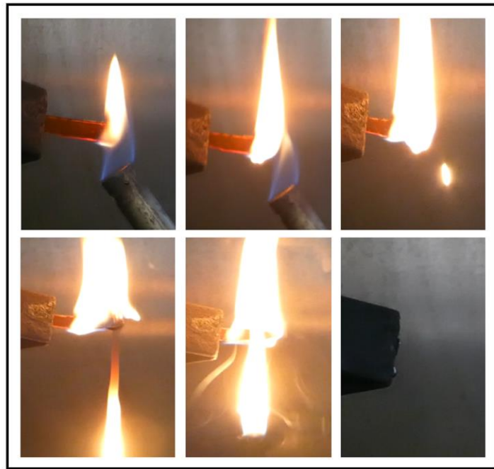
Figura 63: test alla fiamma del materiale di riferimento
