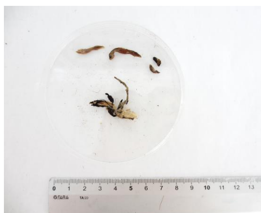
Fig. 26 - Contaminanti individuati nel campione CRMT4 corrispondenti a: alghe e pesciolini non ulteriormente identificabili
