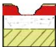
Fig. 19 Esempio di crettatura di essiccamento
