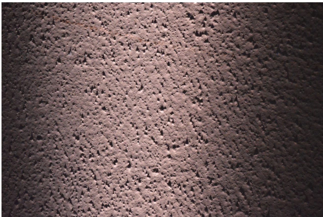
Fig. 55 Differenza di granulosità tra diverse aree delle campiture - zona danneggiata.
