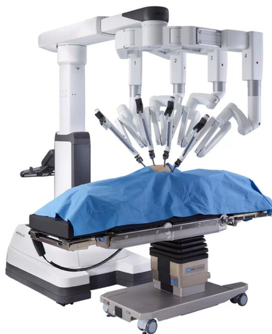
micromovimenti estremamente precisi e delicati che ne aumentano la performance. I robot utilizzati attualmente sono quelli che vengono definiti *master slave manipulators*, di cui fanno parte il *da Vinci surgical system*<sup>®</sup> e lo *Zeus system*<sup>®</sup>: in particolare il *da Vinci system*<sup>®</sup> nella sua ultima versione *Xi* è il device robotico che presenta il maggior impiego a livello globale. [16] [Figura 2 ]
