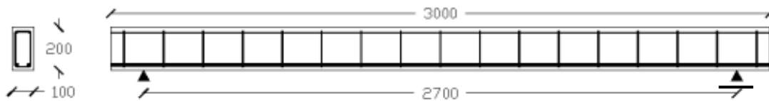
Figura 29: Trave in cemento armato di Hughes & Speirs (da Cotsovos e Christos)
