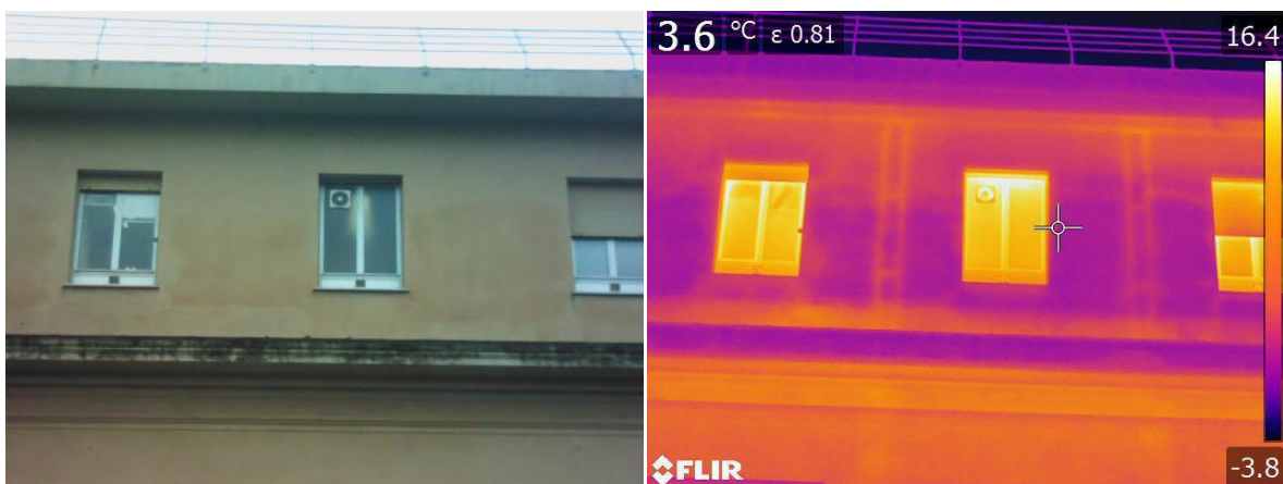
Figura 13: Rilevazione termografica degli elementi strutturali in c.a. (da Annovazzi e Boletto)
