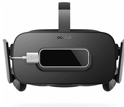
Figura 1.14 – Leap Motion attaccato a Oculus Rift per implementate la funzione di hand tracking 15
