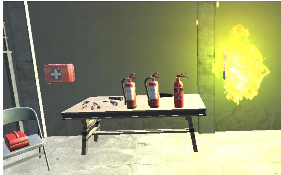
Figura 2.13 – Interno del magazzino dove avviene il training iniziale: l'utente deve avvicinarsi agli estintori, leggere le etichette e utilizzare quello più adatto per spegnere il fuoco che genera da un quadro elettrico
