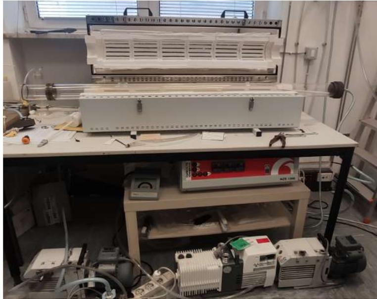
**Figura 4.2:** Forno del CNR-Spin di Genova utilizzato per la cottura di alcuni campioni per le misure di magnetizzazione e dei vamas.
