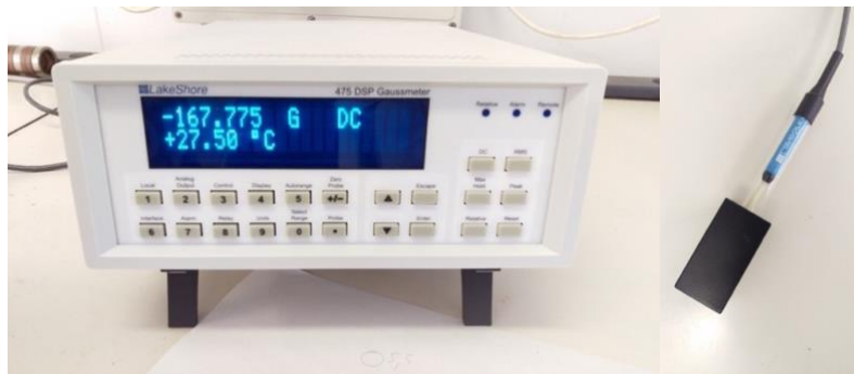
Fig. 16: Gaussmetro e sonda utilizzati per le misure; la sonda è in fase di calibrazione, all'interno dell'apposita camera.
