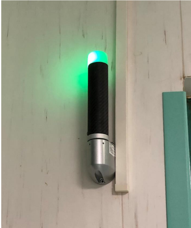
Figura 13. Esempio di sonda Geiger equivalente a quella posta nella camera a pareti piombate.
