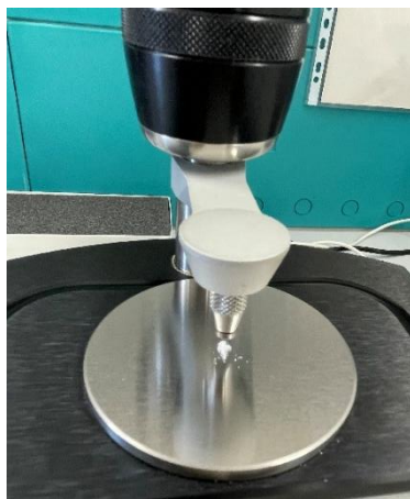
Figura 10: campione di cocaina analizzato con spettroscopia FT-IR nel laboratorio chimico ADM di Savona
