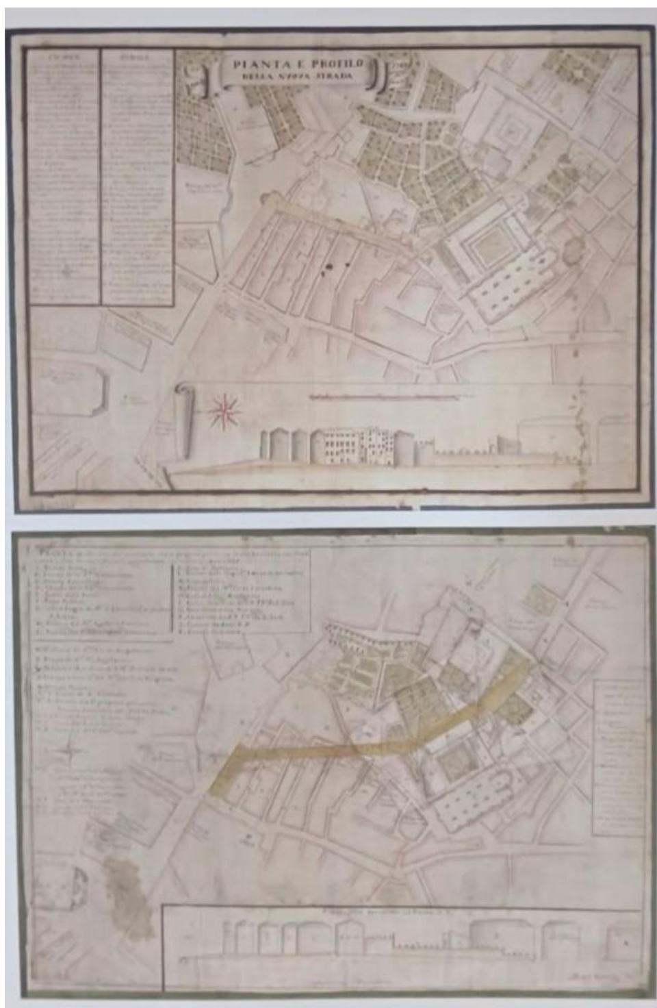
Fig. 15 - Michele Codeviola, Pianta e profilo della nuova strada , 1759-1762. Il disegno ante operam documenta l'assetto morfologico e altimetrico dei terreni compresi tra Palazzo Grimaldi e Palazzo Brignole, evidenziando i dislivelli, i profili degli edifici e le quote dei terrazzamenti destinati all'esproprio per il tracciato di Strada Nuovissima . (In: G. Rotondi Terminiello, Due disegni ritrovati , in E. Poleggi [a cura di], Palazzo Grimaldi della Meridiana: una dimora aristocratica genovese , Genova, Sagep, 2010, p. 173).
