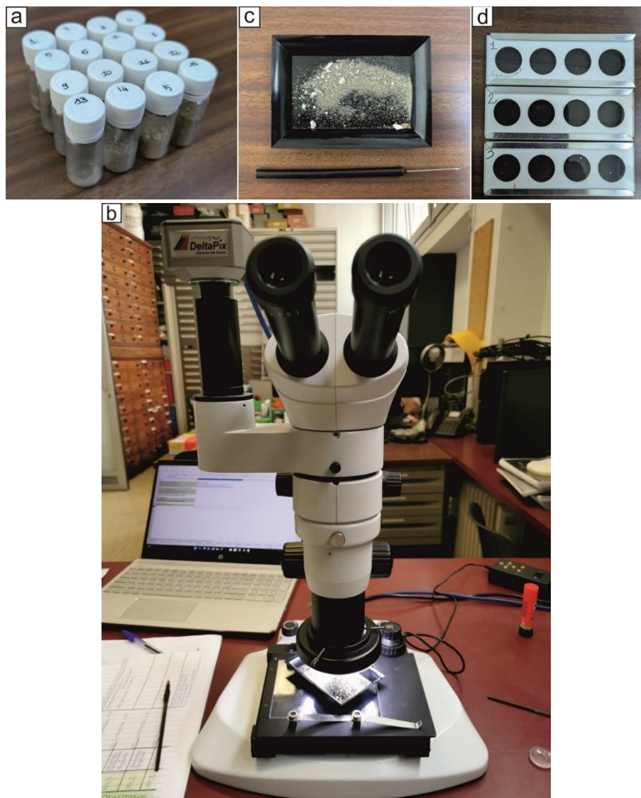
Figura 2: a: Campioni sciolti; b: stereomicroscopio GZ808; c: Vaschetta portacampione e aghetto; d: Microteche numerate
