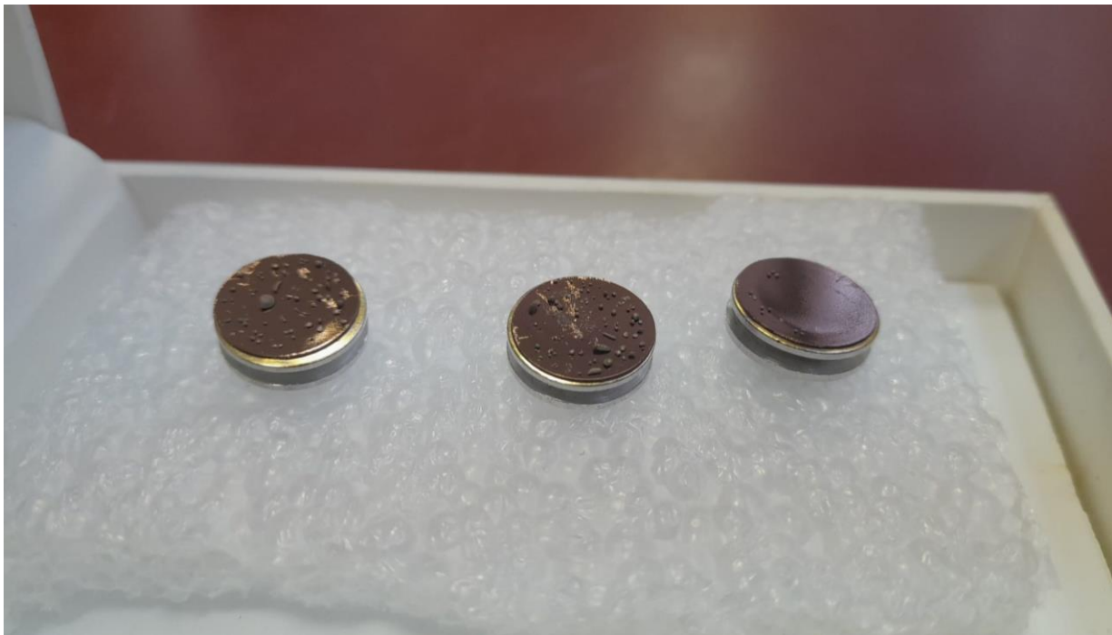
Figura 3: Stub preparati per l'acquisizione delle immagini tramite un microscopio elettronico a scansione (SEM) Tescan Vega 3.
