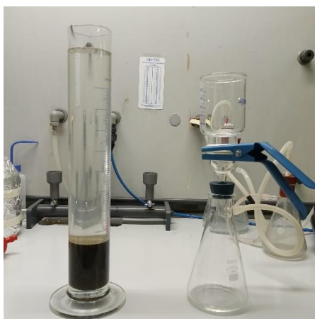
Figura 3.3: A partire da sinistra cilindro con sedimento e soluzione di ioduro di sodio, bicchiere di filtrazione e supporto poroso fissato da delle pinze, sotto la beuta per la filtrazione a vuoto
