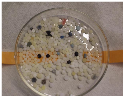
Fig. 1.5: Pellet plastici di diversa composizione e colore, raccolti in capsula Petri (Rios Mendoza et al., 2007)
