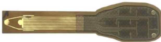
Figura 3: Matrice di sensori usata per il lavoro.
