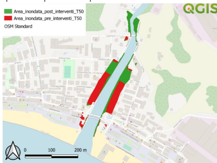
Fig. 8.11 Mappa comparativa dell'analisi 1D pre e post-interventi dell'estensione dell'area inondata del torrente Petronio per T50 (QGIS).
