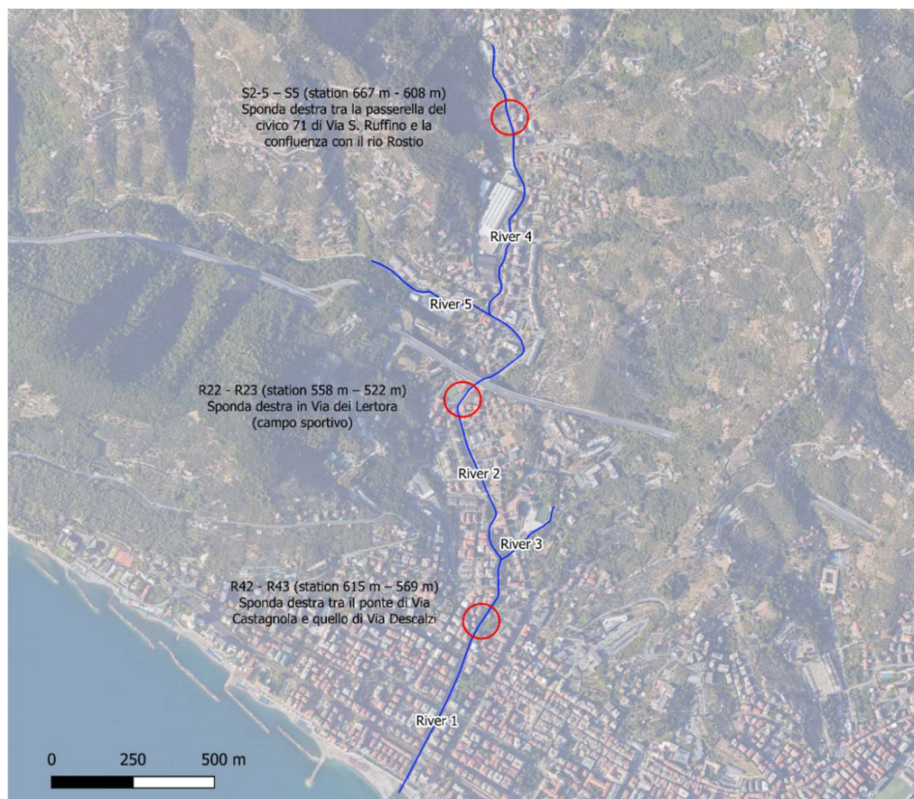
Figure 5.1 - Tratti più vulnerabili ad esondazione spondale
