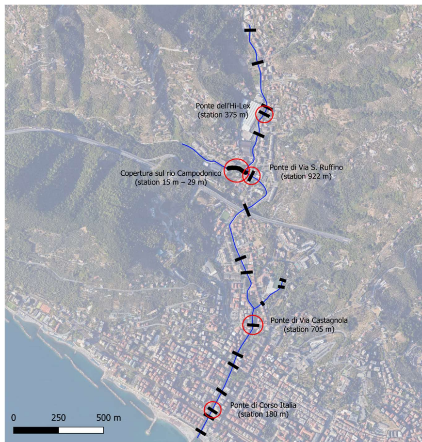
Figure 5.6 - Ponti più vulnerabili al sormonto
