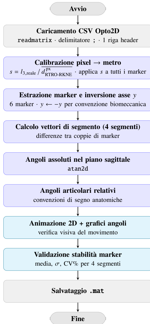
Figura 7.16: Pipeline di pre-processing dei dati Opto2D.
