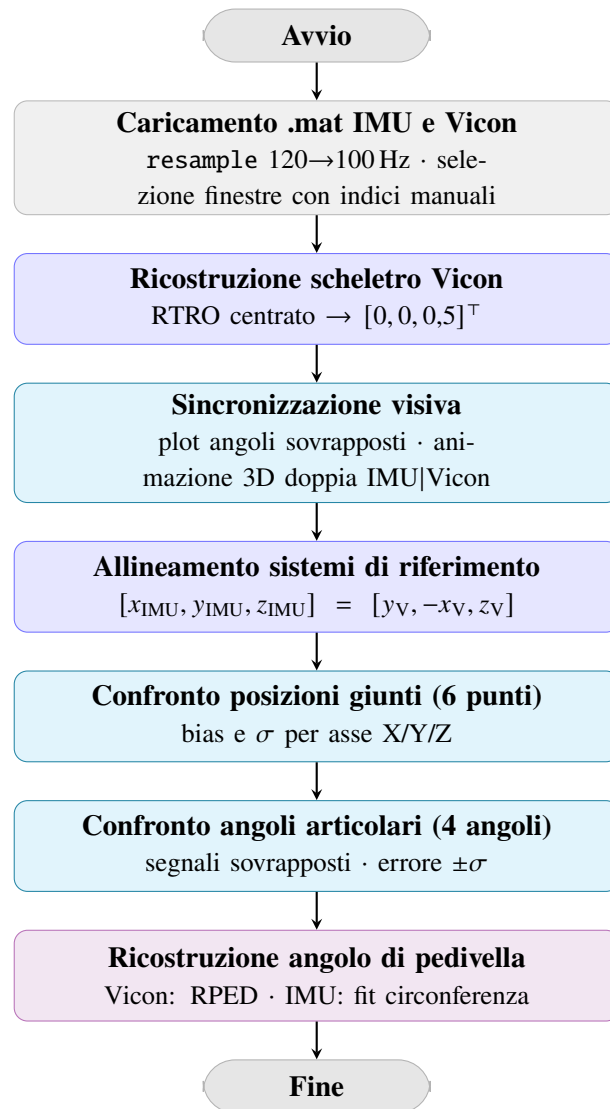
Figura 7.12: Pipeline di confronto IMU–Vicon.
