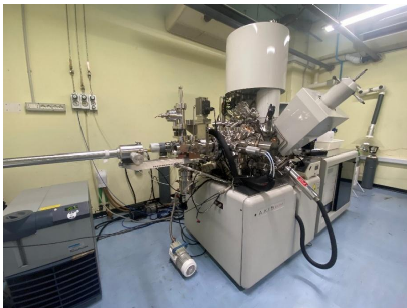
Figura 27: spettrometro fotoelettronico a raggi X Kratos Axis Ultra DLD.
