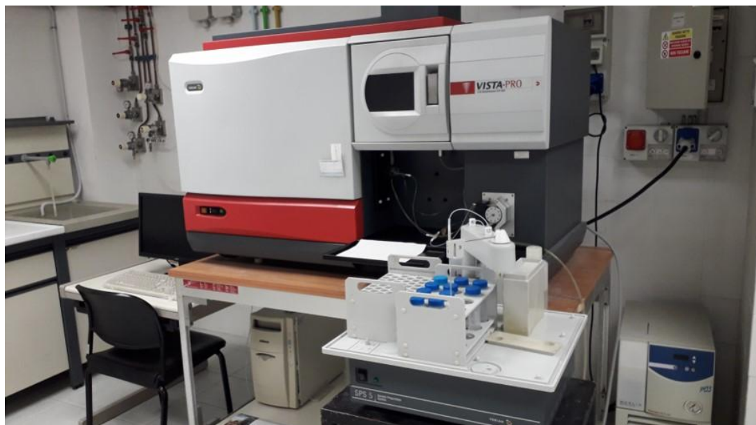
Figura 25: spettrometro di emissione atomica con sorgente ICP Varian Vista Pro.
