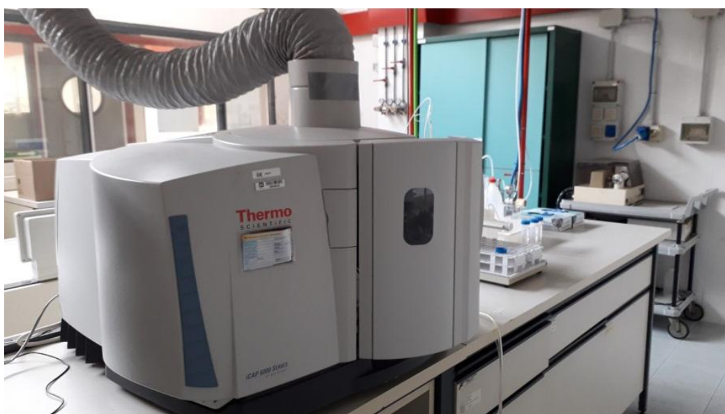
Figura 24: spettrometro di emissione atomica con sorgente ICP Thermo Scientific iCAP 6300 Duo.
