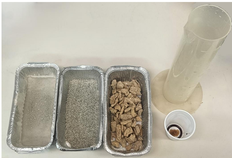
Figura 3.9 – Mix design della malta con aggregati NRG-Wood
