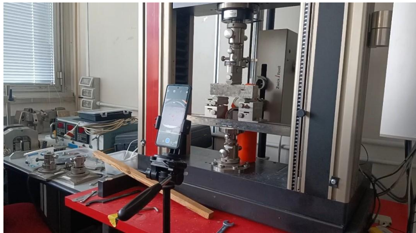
Figura 3.13 – Prova di flessione con macchina Zwick Roell Z050
