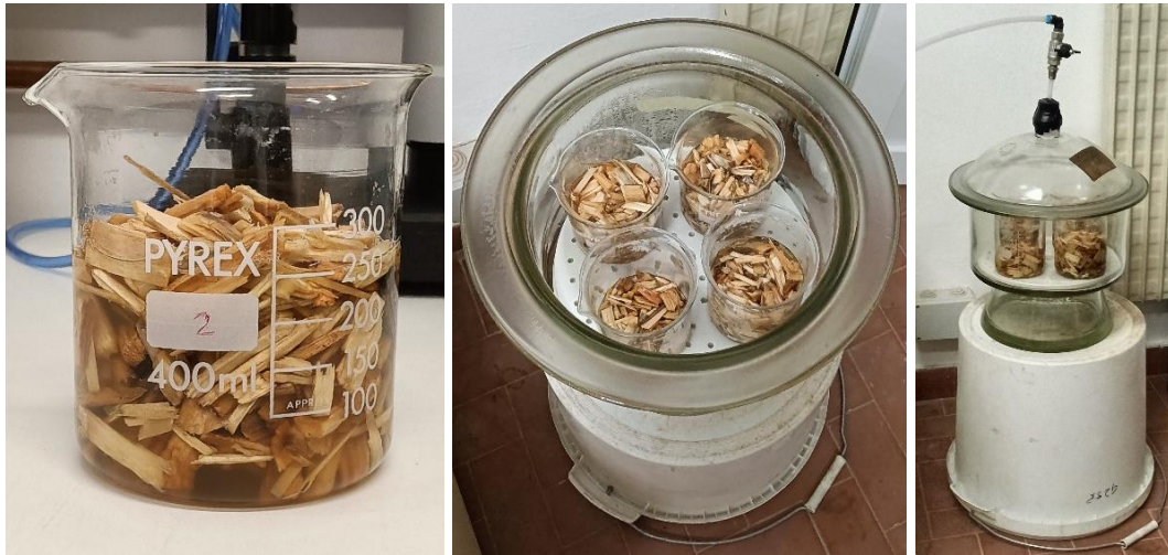
Figura 3.7 – Processo di impregnazione degli aggregati lignei: aggiunta del PCM in fase liquida (a), inserimento nella camera a vuoto (b), saturazione (c)
