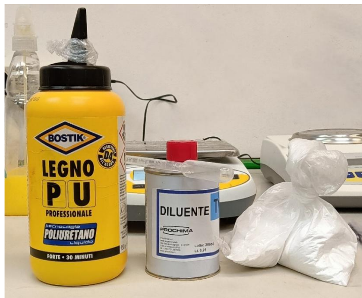
Figura 3.8 – Componenti per il rivestimento degli aggregati NRG: adesivo poliuretanico, diluente e PCM microincapsulato
