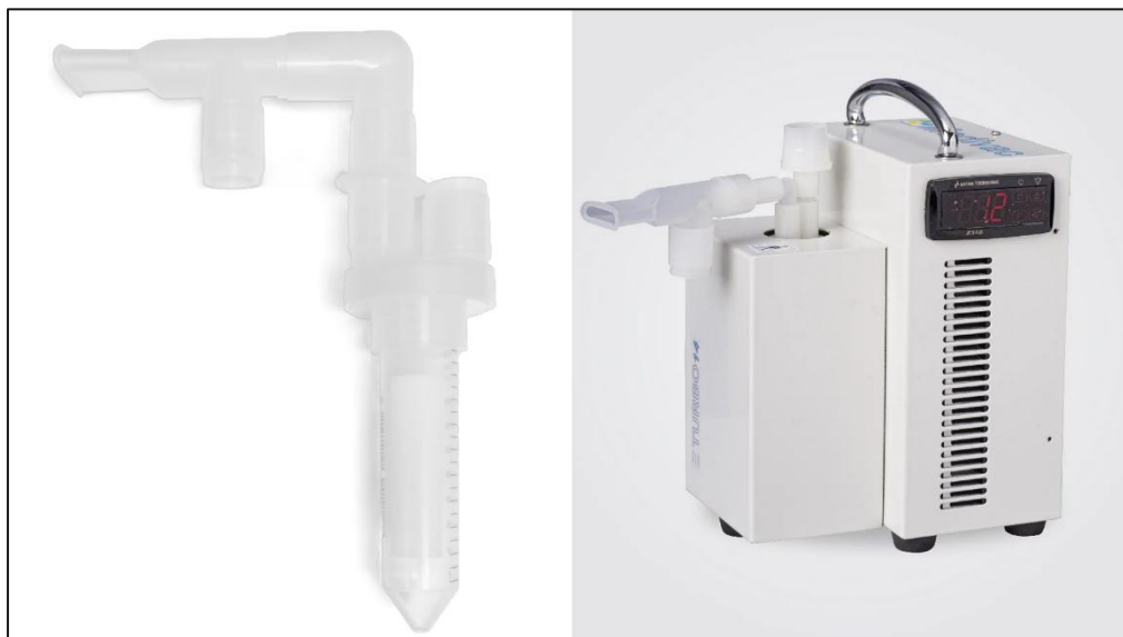
Figura 6. Dispositivo per la raccolta del campione di EBC, caratterizzato da boccaglio e provetta Falcon (a sinistra) e dalla camera refrigerante (a destra) [108].
