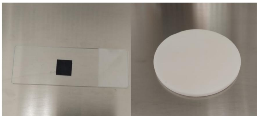
Figura 7. Supporti in silicio monocristallino (a sinistra) e in allumina (a destra).
