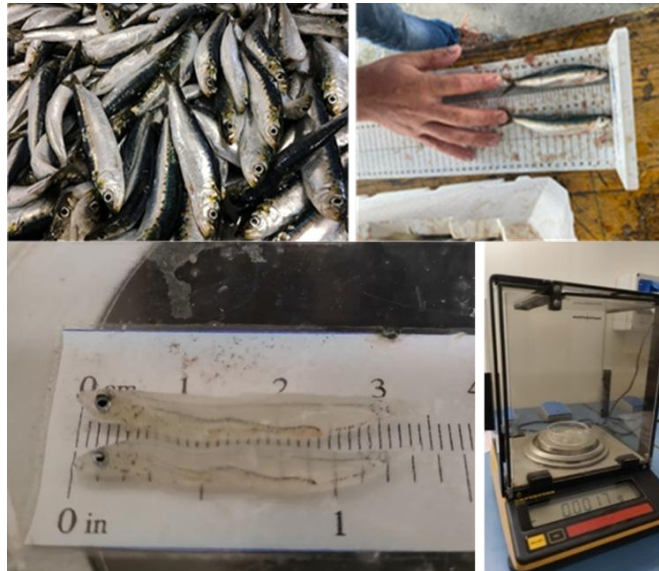
Figura 15: Ittiometro e bilancia di precisione utilizzati per rilevare la lunghezza e il peso singolo degli esemplari campionati.
