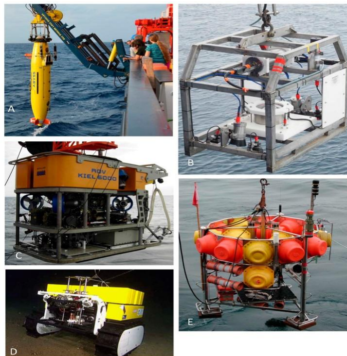
Figura 7: La nuova frontiera tecnologica: (A) veicolo sottomarino autonomo (AUV ABYSS); (B) sistema di osservazione del fondo oceanico; (C) veicolo a comando remoto (ROV Kiel 6000); (D) cingolato telecomandato; (E) sistema lander stazionario equipaggiato con esche (Brandt et al., 2016)
