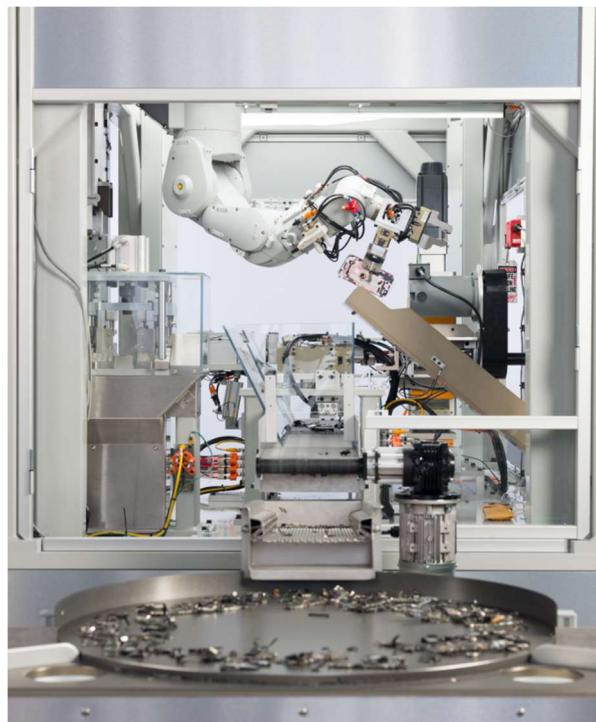
Figura 3.7: Il robot Daisy di Apple per il disassemblaggio automatizzato degli iPhone
