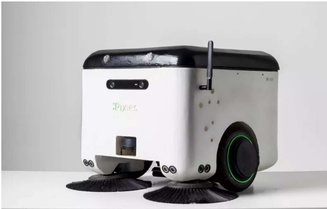
Figura 4.4: Pixies, robot urbano a energia solare per la pulizia delle città
