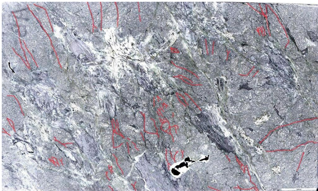
Figura 4.16: L'immagine mostra la sezione AB1.2 caratterizzata da una fitta rete di fratture, in evidenza vengono mostrate quelle contenenti olivina microcristallina (Ol 2). Si osserva che queste fratture secondo la loro disposizione geometrica formano angoli caratteristici dei sistemi di fratture coniugate. La scala in basso a destra indica 5000 \mu m
