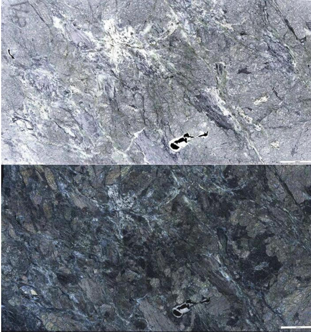
Figura 4.10: Panoramica della sezione AB1.2 a nicols paralleli e a nicols incrociati. La roccia presenta un grado di deformazione avanzato, non presenta foliazione preferenziale. All'interno della sezione sono ancora distinguibili i minerali di mantello: olivina e minerale opaco (spinello), mentre i pirosseni non sono più distinguibili. La scala in basso a destra indica 5000 \mu m.
