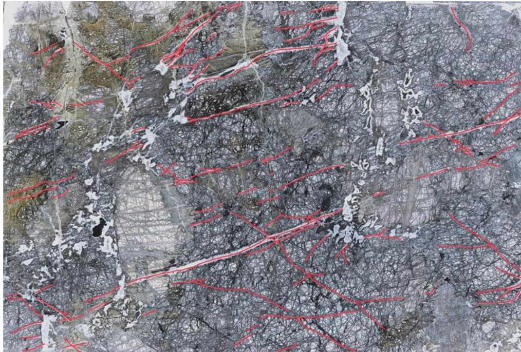
Figura 4.21: L'immagine mostra la sezione AB2.1 caratterizzata da una fitta rete di fratture si osserva che queste fratture secondo la loro disposizione geometrica formano angoli caratteristici dei sistemi di fratture coniugate. La scala in basso a destra indica 5000 \mu m.
