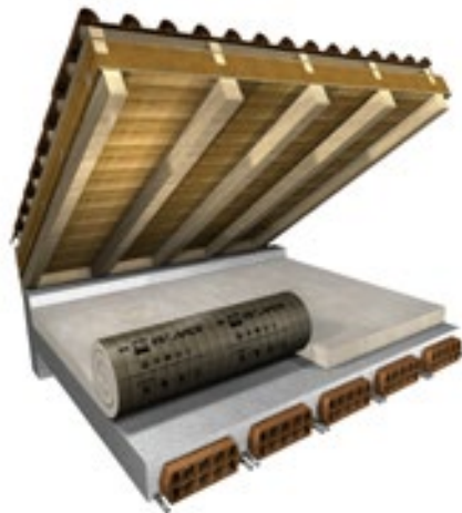
Fig. 5.5 Isolamento del sottotetto [Fonte: Isover]
