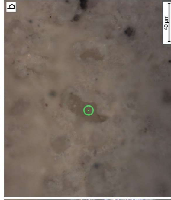
Fig. 2: a) Particolare degli strati S3c e S2e (MOLP, XPL; cerchio verde: punto analisi); b) particolare del punto di analisi Raman nello strato S3c (cerchio verde); analisi effettuata tramite sorgente laser 532 nm (20-30 mW), grating 2400 grooves/mm, tempo di acquisizione 40 secondi, 2 accumulazioni; c) spettro Raman del punto di analisi indicato in Fig. 2b; valori in blu: picchi relativi alle resine silossaniche (JAYES et al., 2003); valori in rosso: picchi relativi al rutilo (RRUFF); valori in nero: picchi relativi alla calcite (RRUFF).
