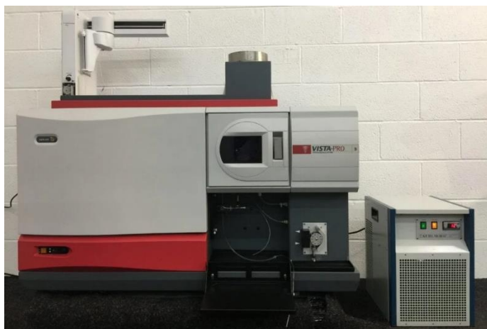
Figura 20: VISTA-PRO CCD Simultaneous ICP-AES utilizzato per l'analisi [37] .
