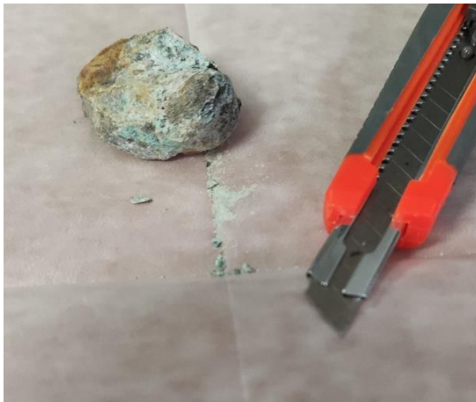
Figura 17: Selezione delle frazioni contenenti rame [40] .
