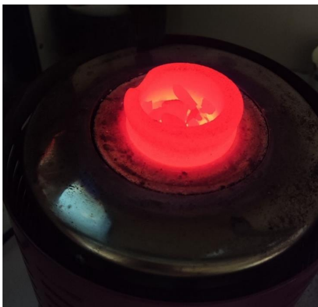
Figura 12: Crogiolo incandescente durante il processo di riduzione a temperature superiori a 1000°C [40] .
