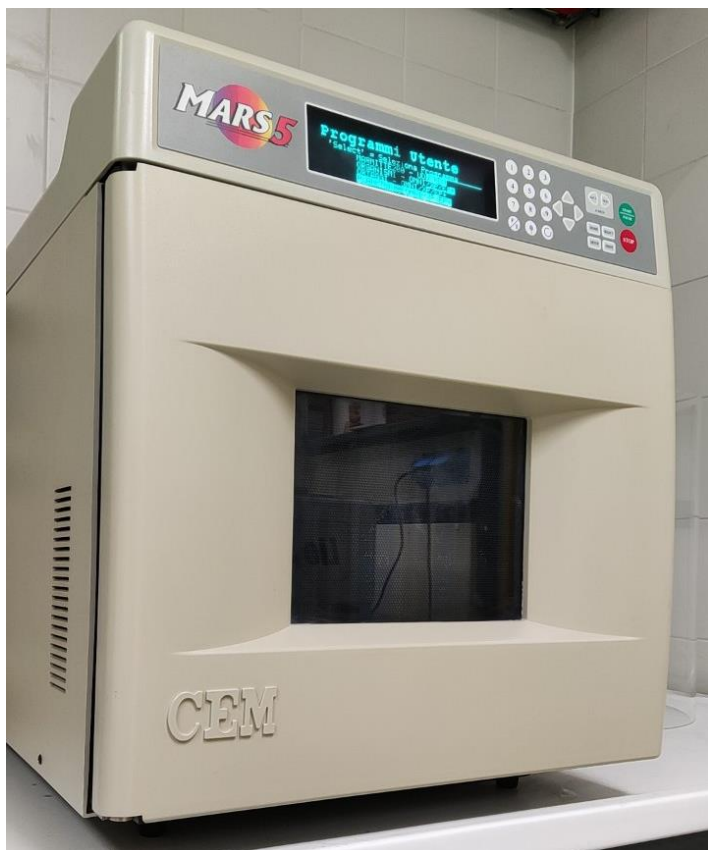
Figura 18: Microonde CEM Mars 5 utilizzato per l'analisi [40] .
