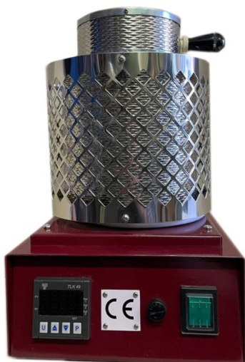
Figura 8: Esempio di forno elettrico a induzione da laboratorio [39] .
