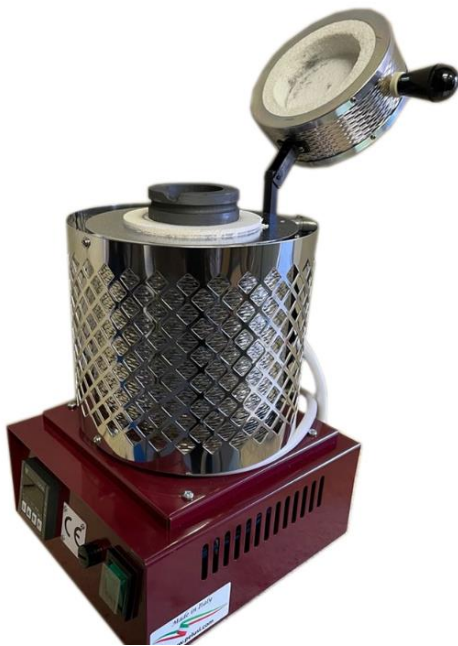
Figura 9: Visione completa del forno e del crogiolo al suo interno [39] .
