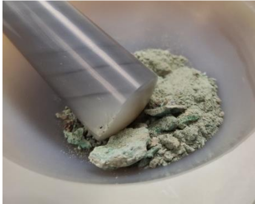
Figura 21: Campione di minerali macinato finemente in un mortaio d'agata [40] .
