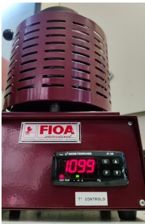
Figura 10: Forno a resistenza con crogiolo di grafite utilizzato per tutte le analisi metallurgiche in laboratorio [40]
