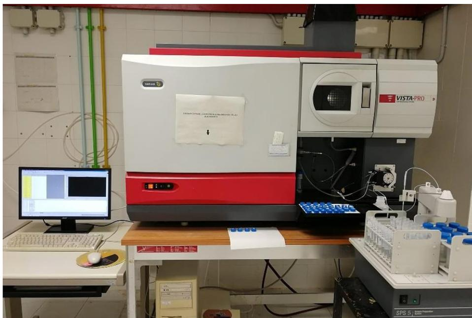
**Figura 4.4** Spettrometro ICP-AES Vista PRO della Varian Inc.
