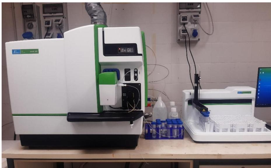
**Figura 4.3** Spettrometro ICP-MS NexION 2000 con autocampionatore S23 della Perkin Elmer
