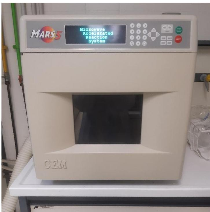
**Figura 4.5** Mineralizzatore a microonde MARS-5
