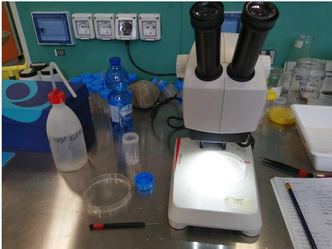
Figura 19 – Postazione di lavoro per l'analisi e l'identificazione dei campioni. Si possono vedere stereoscopio ottico, contenitore per gli organismi identificati, pinzette entomologiche, capsula di Petri, acqua distillata ed etanolo al 70%.
