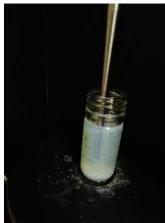
Figura 5: effetto Tyndall ottenuto in seguito a sonicazione con Sonifier® del marchio BRANSON.
