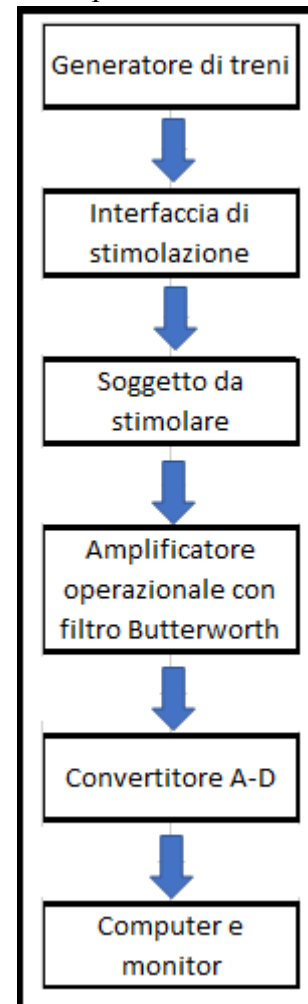
Figura 7. Schematizzazione dei dispositivi in serie utilizzati nel corso delle registrazioni.
