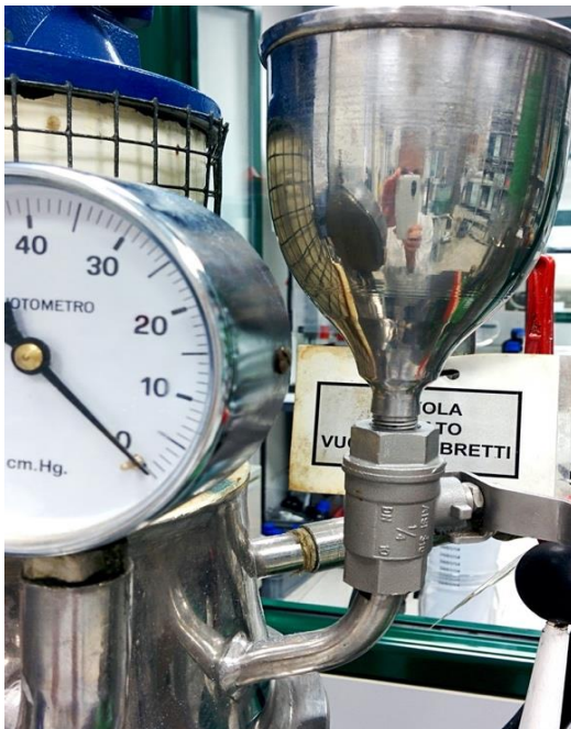
Figura 13 Turboemulsore mambretti. Manometro e imbuto (Foto scattata presso il laboratorio Vevy Europe)
