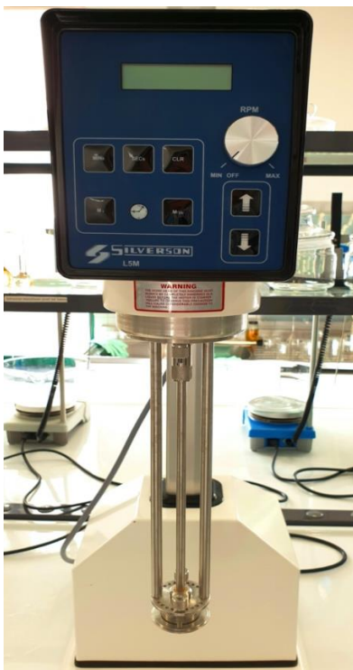
Figura 15 Omogeneizzatore Silverson (Foto scattata presso il laboratorio Vevy Europe)
