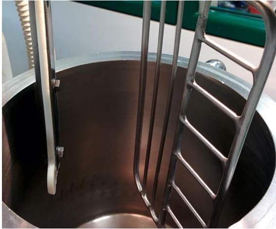
Figura 14 Turboemulsore Mambretti. Pale del miscelatore planetario (Foto scattata presso il laboratorio Vevy Europe)
